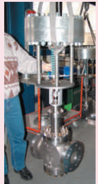
Détendeurs automoteurs très forte détente et haute température High pressure and temperature reducing valves
