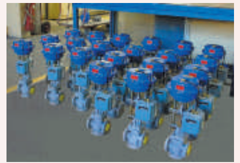
Vannes de régulation 3 voies 3 ways control valves
